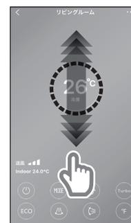
温度設定の表示を指でタッチしながら上下にスライドさせることで、設定温度を変更します。指を離すと、表示されている温度で目標温度が設定されます。
