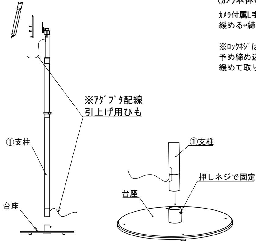
③カメラ本体を取り付けプレートに固定する。
