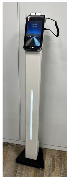
※カウンタースタンドの取り付け金具部分の角度は手で押せば変更できますが、固定する場合、六角レンチ(別売)の使用を推奨します。
