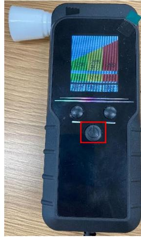
②右ボタンで「簡易測定モード」と「精確測定モード」を切り替えが行えます。画面上部（黄色丸で囲まれている部分）が選択されているモードとなります
