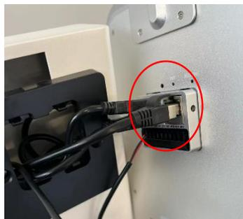
⑤フロアスタンドから露出しているDCプラグをカメラ裏面に差し込む。
