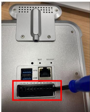
② 線を挿し込む穴の裏のネジを、準備した精密マイナスドライバーで緩め、線を挿し込む端子を開きます。
