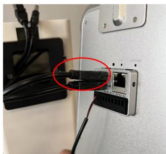
④フロアスタンドから露出しているLANケーブルを、カメラ裏面に差し込む。
