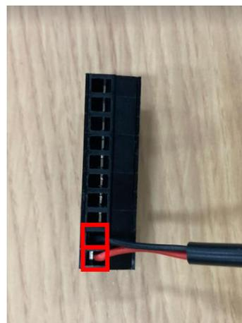
④ 線を挿し込んだ穴のネジを締めます。
