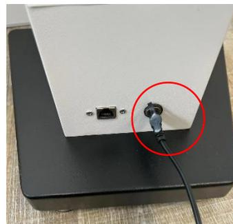
⑧アルコール検知機をサイドにある右のUSBに差し込み、ホルダーにアルコール検知を、液晶画面を上向き、吹込み口を顔認証カメラ側に向けて、設置します。
