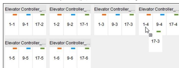
図 16-6 既存のリレータイプの置き換え
