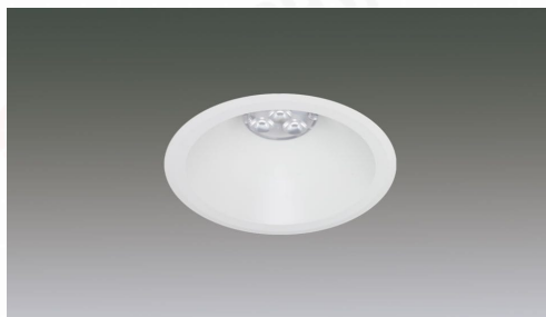
LEDダウンライトリニューアルタイプΦ125-Φ75 5灯 1/2配光角25°3000K 調光対応
