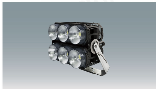
スタジアム照明Field Vision 110,000lm 5000K Ra70 1/2ビーム角40°
