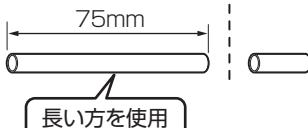
③電源線・アース線を絶縁チューブに挿入する。
