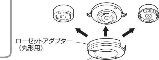
③ガイドシートの線位置にランプ本体の▲を合わせながら、引掛端子を配線器具に差し込み、時計方向(右)へ少しだけゆっくり回し、止まれば完了です。
