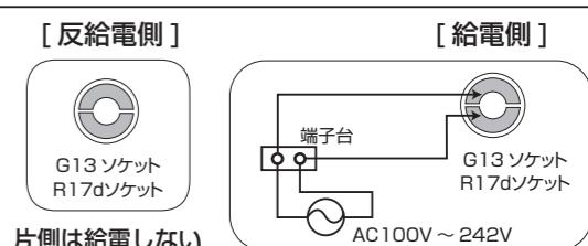
※配線変更後は、器具の見えるところに必ず「LEDランプ専用配線済」シールを貼ってください。
