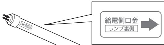
2 給電側のソケットに、ランプの給電側口金を取り付け、点灯する事を確認する
