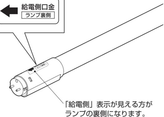
「給電側」表示が見える方がランプの裏側になります。
