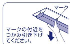
**注意** 電源コネクタは、必ず先に外してください。先にフックバネを外すと、電源コネクタが引っ張られて破損したり、LEDユニットが落下して破損やけがをしたりするおそれがあります。
