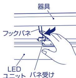
② 片側のフックバネが<詳細図>位置であることを確認し、もう一方のフックバネも同様に取り付けてください。
