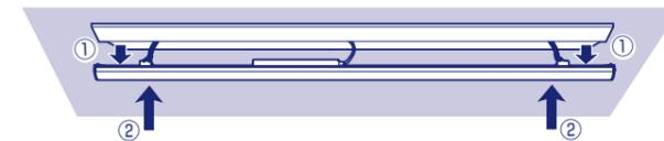
**警告** フックバネの位置が正しくないと、LEDユニットを水平に取り付けできません。また落下して重大なけがの原因になります。
