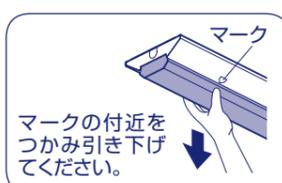
**注意** 電源コネクタは、必ず先に外してください。先にフックバネを外すと、各コネクタが引っ張られて破損したり、LEDユニットが落下して破損やけがをしたりするおそれがあります。
