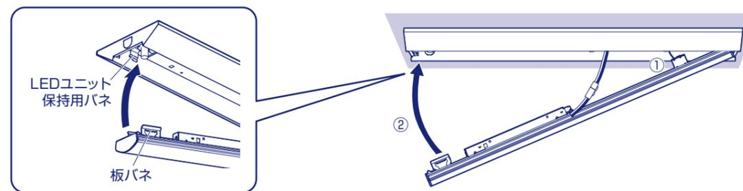
**警告** ●フックバネの位置が正しくないと、LEDユニットを水平に取り付けできません。また落下して重大なけがの原因になります。
