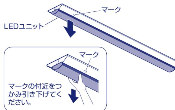
**警告** LEDユニットは勢いよく外さないでください。電源コネクタが引っ張られて破損したり、LEDユニットが落下して破損やけがをするおそれがあります。
