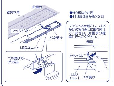
②片側のフックバネが<詳細図>位置であることを確認し、 もう一方のフックバネも同様に取り付けてください。
