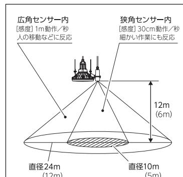
※人感センサー感知範囲は、器具の取り付け高さによって変動します。取り付け高さが高くなると感知範囲は広くなります。
