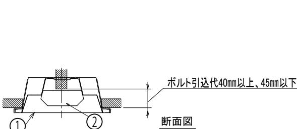
**〈取り付けボルトの器具内寸法〉**
