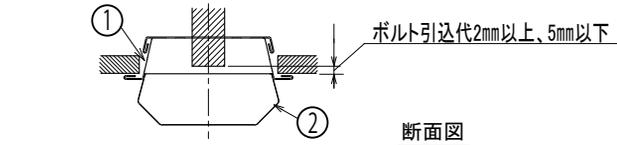
〈取り付けボルトの器具内寸法〉
