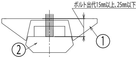
〈取り付けボルトの器具内寸法〉
