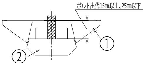
〈取り付けボルトの器具内寸法〉
