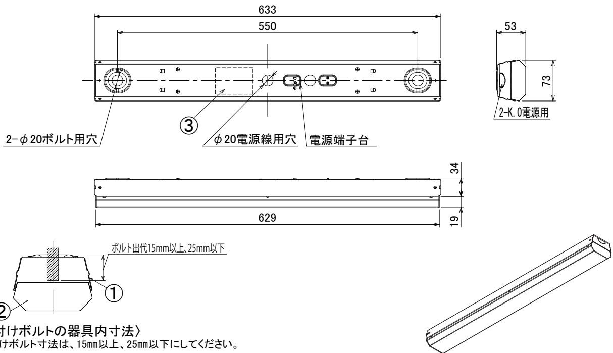
〈取り付けボルトの器具内寸法〉
