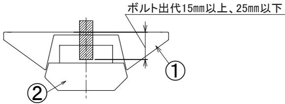
〈取り付けボルトの器具内寸法〉
