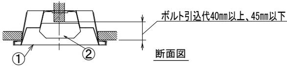
〈取り付けボルトの器具内寸法〉
