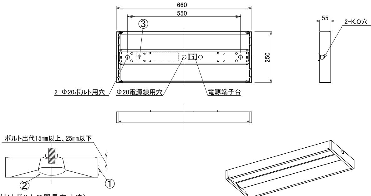
**〈取り付けボルトの器具内寸法〉**
