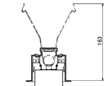
〈施工時最大高さ寸法〉
