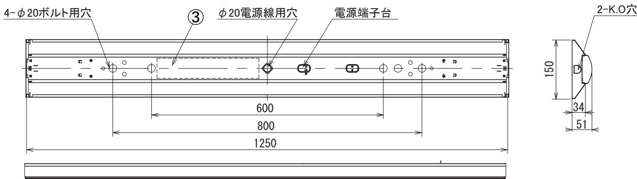
〈取り付けボルトの器具内寸法〉
