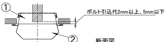
〈取り付けボルトの器具内寸法〉
