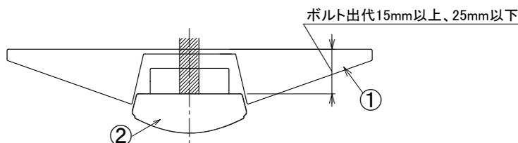
〈取り付けボルトの器具内寸法〉
