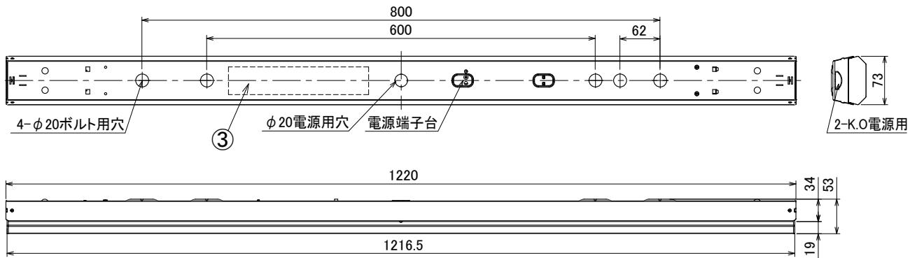
〈取り付けボルトの器具内寸法〉
