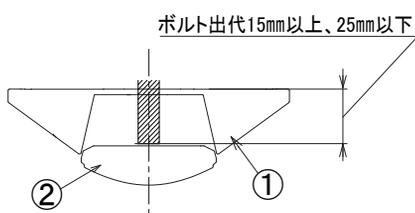
〈取り付けボルトの器具内寸法〉
