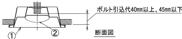
〈取り付けボルトの器具内寸法〉
