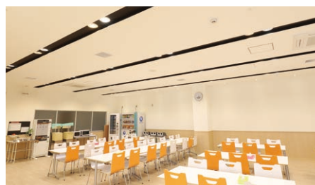
食堂は、電球色と昼白色のLEDダウンライトを組み合わせ使用。時間帯や用途に合わせて光色を変え、最大限リラックスできる空間にしています。
