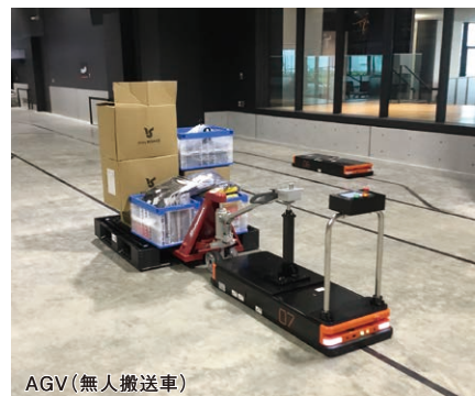
AGV（無人搬送車） 物流センター内で商品を自動搬送する、磁気を利用した設備。人が荷物を運ぶ負担を減らし、省人化を支えます。
