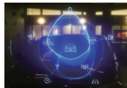
ガラスドアに設置されたインターフェース。手で触れることで自動車の状況を確認したり照明を操作したりできます。
