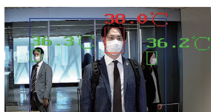
ドーム型は同時に最大20人まで非接触での発熱測定が可能。距離は最大3m先から検知できます。
