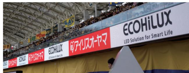
電光掲示板「復興きずなLEDビジョン」には、選手紹介や復興応援メッセージ、スポンサー企業の広告を表示。8mmピッチに配置された高輝度のLEDによって、日中でも鮮明な映像表示が可能です。独自の映像技術によって動きのある映像でも、なめらかに表示します。
