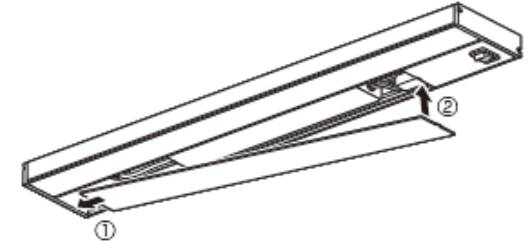
①外側を差し込み、②逆端を本体に押し込んでカバーを取り付けます。
