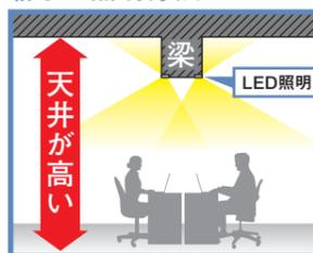
梁の下部に薄型の照明器具を設置し、空間を最大限に広げました。上下2方向を照らす独自の照明方法で、机上面の明るさを確保し、広がりを感じる天井空間になっています。
