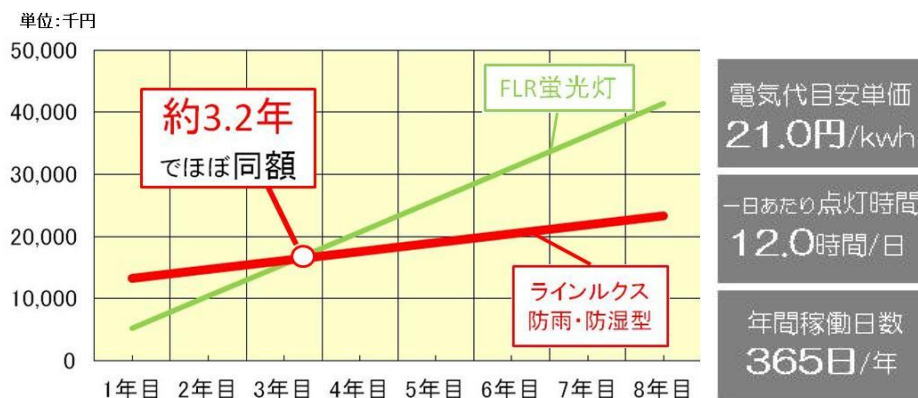
<ラインルクスと FLR 蛍光灯のコストシュミレーション※ 2 >
