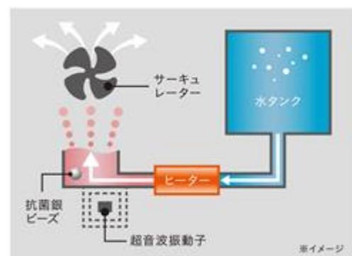
※1 ヒーターで加熱した温水を超音波振動により霧状にして放出する方式。
