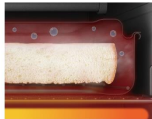
2 凝縮過熱水蒸気が食パンを包み込む
