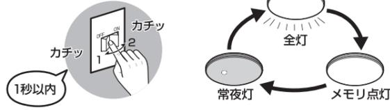
**警告** 壁スイッチをONにしても点灯しない場合は、壁スイッチを短く(1秒以内)操作して点灯状態を切り替えるか、壁スイッチをONにしてリモコンで点灯してください。
