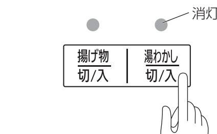
※ 湯わかしの停止後、再度お湯をわかすときは、加熱キーを使用してわかし、沸騰したら加熱を停止してください。
