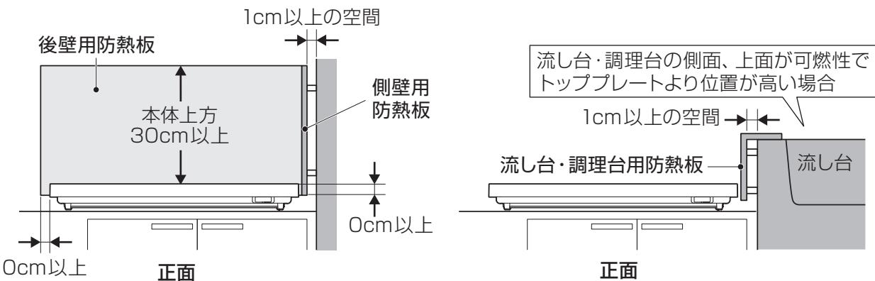
※ 防熱板を取り付ける場合、室温35°Cのとき、機器周囲の木壁温度が100°Cを超えない断熱性があることを確認してください。
