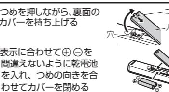
●電池の寿命は新品のアルカリ乾電池を使用したときで、約1年です。付属の電池は動作確認用であり、上記よりも消耗することがあります。
