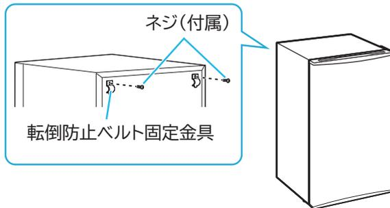
②転倒防止ベルト(市販)を転倒防止ベルト固定金具に取り付ける
