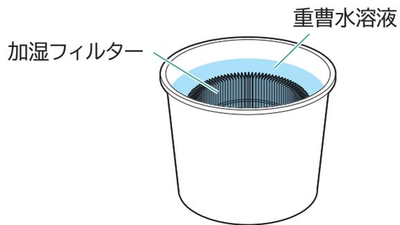
2 重曹水溶液が残らないよう、新しい水でしっかりすすぎ洗いする
