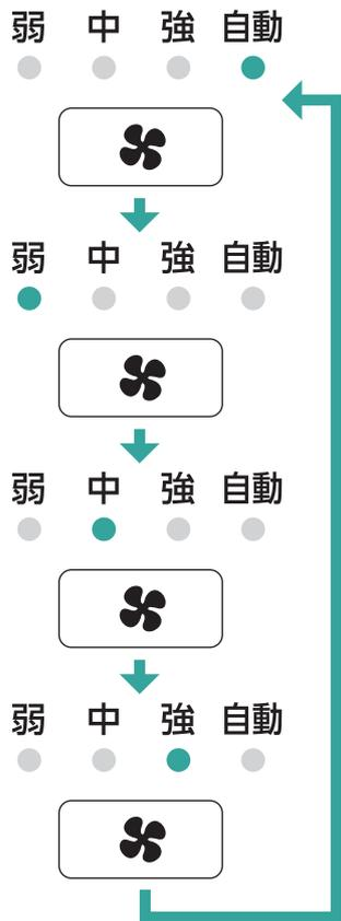
・ 自動モードは、空気の汚れに応じて自動で風量を調節します。
