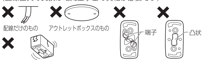
破損、またはグラつくもの 電源端子露出 凸部のあるもの
