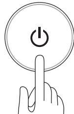
※左右首ふり中またはサークュレーター扇風機が正面を向いていない場合は、サークュレーター扇風機が正面を向いてから停止します。その間、**左右首ふり**ランプが3つとも点滅します。
