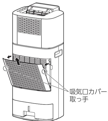
3 吸気口カバー（エアフィルター）と本体の吸気口を掃除機で掃除する
