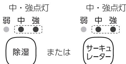
ランプが点灯したら、電源プラグをコンセントから抜き、5秒程経過してから再度電源プラグをコンセントに差し込んでください。それでもランプが消灯しない場合は、以下の点検を行ってください。
